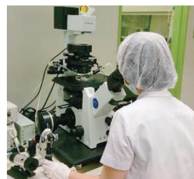
写真1 卵細胞質内精子注入法(ICSI)の実施風景 顕微授精用マイクロマニピュレーションシステム
