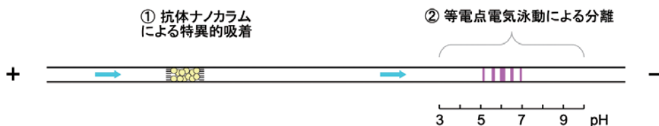
図2 イムノCIEFは生体試料中に含まれる1ng以下のタンパク質の等電点分析が可能です。
