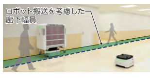
図8: ロボット搬送のイメージ
