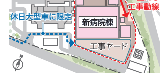
図7: 工事車両の動線計画イメージ
