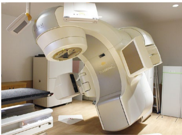
放射線治療装置。体の内部にあるがんの病巣だけに放射線を照射します。
