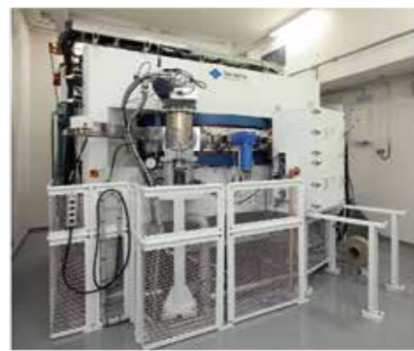
治療に用いられるα線やβ線を放出する放射性核種を製造する中型サイクロトロン(MP-30)
