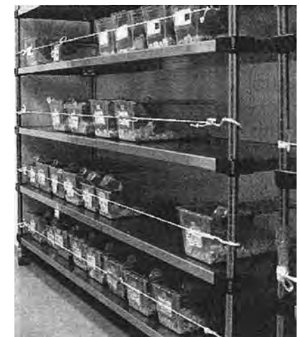
写真18、19 動物用飲用水(限外濾過水)や弱酸性水の備蓄の徹底。人工透析液用容器(7.56L; 附属病院の廃棄物)を活用した限外濾過水および弱酸性水の保管。台車の活用は利便性の他に耐震性もある。
