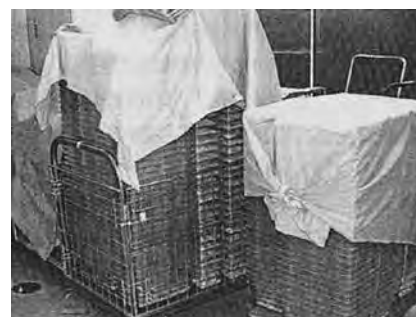
写真15 ケージ類の一時保管のための台車の活用。地震時には台車が動くので、ケージの落下や散乱が少ない。
