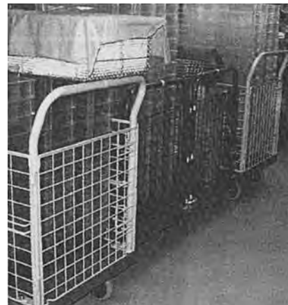
写真16 ラットの飼育にはステンレスエレクターシェルフ(キャスター付き)をダブルにして使用。震度5強の揺れでもケージの落下はなかった。
