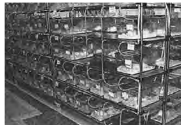
写真16 ラットの飼育にはステンレスエレクターシェルフ(キャスター付き)をダブルにして使用。震度5強の揺れでもケージの落下はなかった。
