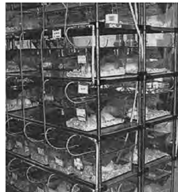
写真16 ラットの飼育にはステンレスエレクターシェルフ(キャスター付き)をダブルにして使用。震度5強の揺れでもケージの落下はなかった。
